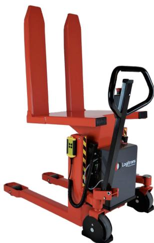
Der Logitilt dient dazu, produktive und ergonomische Arbeitsplätze für Mitarbeiter zu schaffen, die per Hand Kisten und Gitterboxen entleeren oder befüllen müssen.
