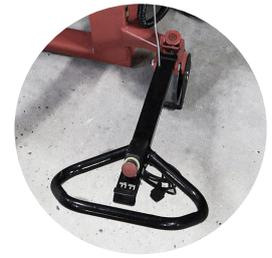
Deichsel zur Seite drehbar für besseren Zugang des Bedieners
